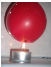
Der mit Wasser gefüllte Luftballon über der Kerze – Ruß hat sich angelagert
